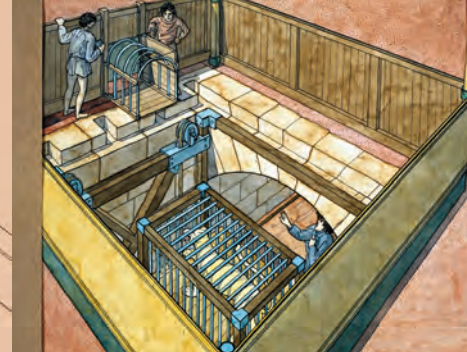
Restitution d'un monte-charge de l'amphithéâtre d'El-Jem.
