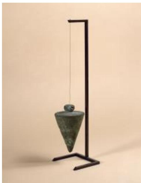
*Plomb d'architecte ou l'arpenteur*
